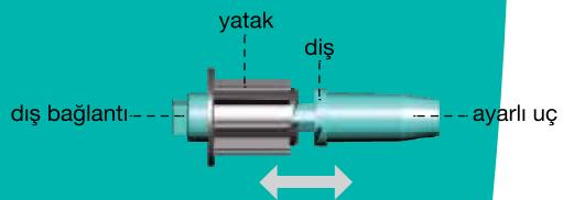
Roll in fly Panjur sistemleri için stor sineklik sistemidir. Standart Roll in fly sistemine ilave olarak bu yeni sistem onceden kurulabilir. Yay kuruldukça herhangi bir önlem almaksızın tek yönlü dişleri vasıtası ile torkunu içinde hapis tutar; yerine takıldığındá ise yaylı butonu sayesinde torku otomatik olarak boru tüle aktarır. Bu özelliği sayesinde tül değişimi ve yay kurulumu kolaylıkla yapılabilmektedir.
